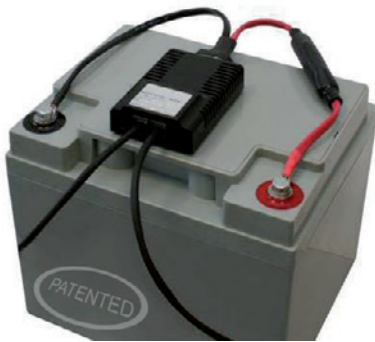
BACS C20 Modul REV 2 mit externem Temperatur-sensor für 12 V Akku-latoren zwischen 7–6000 Ah, mit Einzelspannungs-regelung, LED-Status für Fehleranzeige und Buskabel-Anschlüssen
